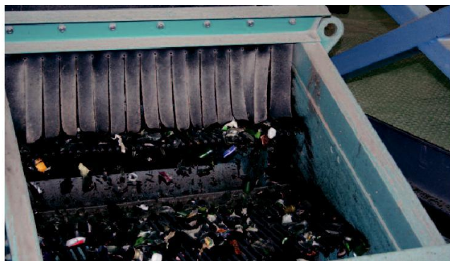
摩根森振动式杆系筛分机 进行预筛分-粗分离
