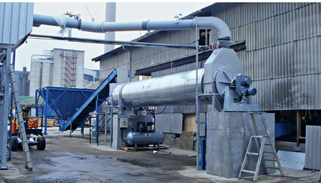
阿盖尔公司的TT型号用于烘干回收玻璃的双层结构的烘干机
