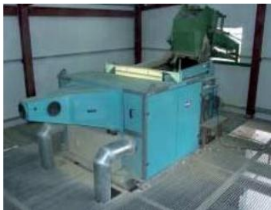
图 1: MikroSort AT 型号光选机，配备两台颜色相机，可双面扫描，用于岩石选别
