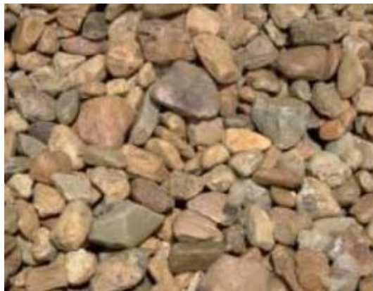
图 4 通过检测器的物料：高含铁量石英
